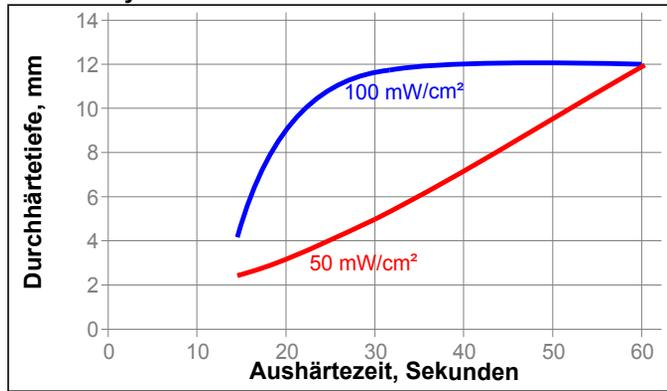
**Aushärtensystem: Elektrodenloser Strahler V**
